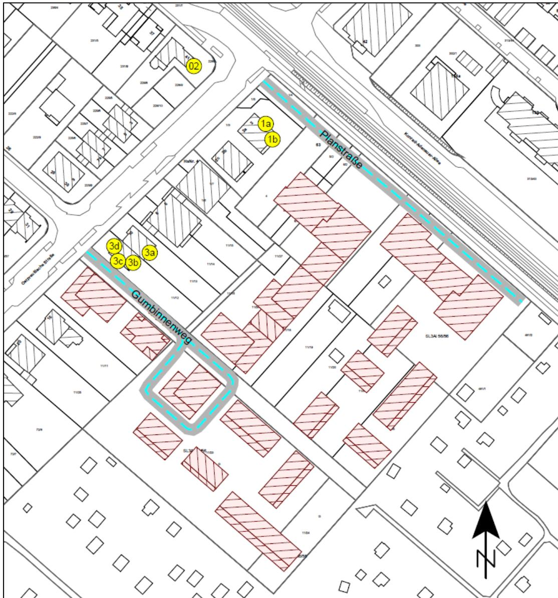
Abbildung 5 Darstellung der relevanten Immissionsorte zusätzlicher Verkehrslärm durch den Neubau von Straßen
